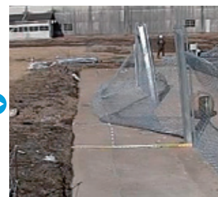
運動エネルギー終息時(重錘停止) (W=3.4m)
