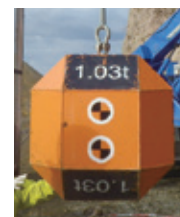
重錘は多面体(26面) 1.03tを使用し、衝突速度25m/secを確認しています。
