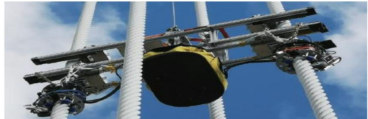
写真)全磁束法による診断風景(長大吊橋ハンガーロープ)
