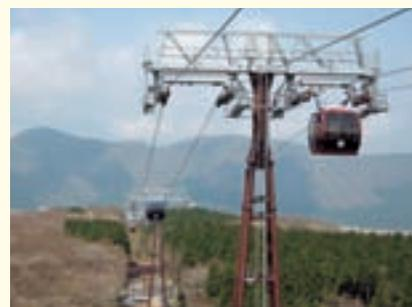
平成12年12月よりリニューアルのため一部運休しておりました箱根ロープウェイが平成19年6月1日に全線の営業運転を再開いたしました。箱根ロープウェイは、第I期線・第II期線の2線からなり、第I期線が平成14年6月、そして今回第II期線が開通し全面開通となりました。I期、II期線とも通称フニテルと呼ばれる複式単線自動循環式ロープウェイであり、輸送人員の増加への対応や天候不良による運休を減少させることを目的とした新しいタイプのロープウェイとなっています。当社は、I期線(線路長1.5km)、II期線(同2.5km)の支え索用ワイヤロープを納入いたしました。(総ロープ重量95.7t)
