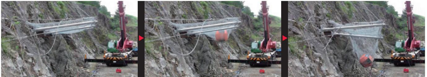
●支柱間隔: 9.0m ●延長: 27.0m ●重錘重量: 1.03t ●重錘速度: 25.3m/s ●衝突エネルギー: 319kJ
