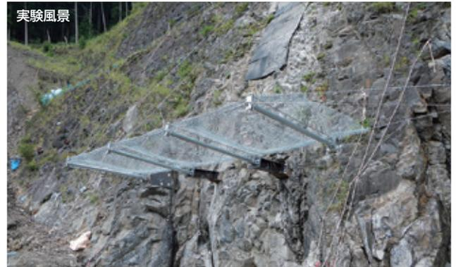
●支柱間隔: 3.0m ●延長: 9.0m ●重錘重量: 1.03t ●重錘速度: 25.3m/s ●衝突エネルギー: 319kJ
