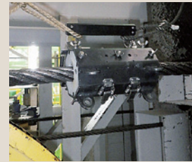
ワイヤロープテスタによる断線測定例
