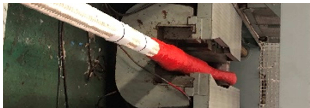
写真) 洋上風力400tf級係留索 破断試験の様子
