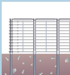
横ロープを設置延長に合わせて展開し、サポート・間隔保持材を設置します。
