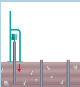
支柱設置位置にフィードをセットし、エアハンマーにて鋼管杭を設置します。
