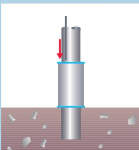
パイプカプラーと支柱の間にスペーサーロッドを挿入し、パイプカプラーの上下の隙間をコーキング等でセメントミルクの漏れ防止処理を行います。
