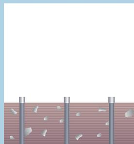
パイプカプラーを鋼管杭頭部に取り付けます。
