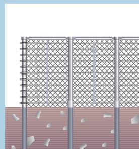
金網を設置延長に合わせて展開し、裾部に補助金網を設置します。
