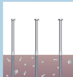
内管を支柱に挿入し、頭部を固定ボルトにて一体化します。
