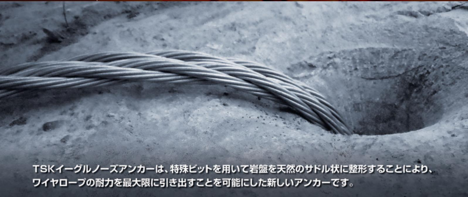
TSKイーグルノーズアンカーは、特殊ビットを用いて岩盤を天然のサドル状に整形することにより、ワイヤロープの耐力を最大限に引き出すことを可能にした新しいアンカーです。
