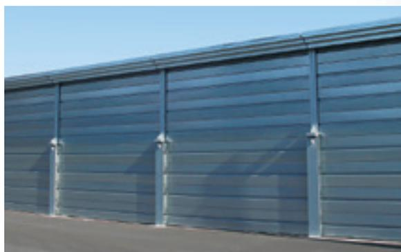
ソフトップガンマは、音の干渉により騒音を消す構造となっています。従来型の遮音壁と比較して騒音低減効果が高く、突出する周波数に対応することも可能です。
