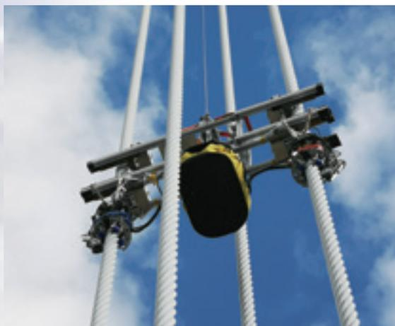
ワイヤロープは強磁性体で構成されており、強く磁化するとケーブル中に磁束が流れる性質を持っています。全磁測定法は、ケーブル中に流れる磁束量がケーブルの断面積に比例するという原理を利用し、健全部及び腐食部での飽和漸近領域における磁束量を比較し腐食度を評価する非破壊検査方法です。
