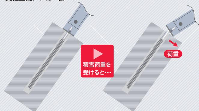
落石荷重時ではヒンジ式構造のため支柱基礎アンカー部に荷重はかかりませんが、積雪時には長期的荷重が支柱基礎アンカー部にかかります。こちらも吊ロープアンカー部と同様に、地表に近いねじ切り部分で曲がる可能性が高くなり、危険性が高まります。
