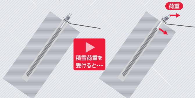
積雪時には、ネット内部に雪が溜まり、ネット全体に長期的荷重(積雪荷重)がかかります。ポケット式ロックネットの吊ロープはネット全体を支えているため、同様に荷重がかかります。吊ロープアンカーにも同様の荷重がかかるため、地表に近い位置(ねじ切り部分)が曲がるという事例が多数報告されており、アンカーとして機能しなくなり危険な状況となります。
