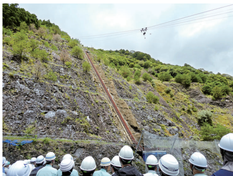
斜面を滑走する重錘、前面にハイアーネット
